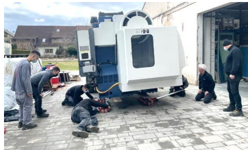
Gemeinsame Vorbereitungsarbeiten zur Einbringung unserer neuen, rund 7 Tonnen schweren Fräsmaschine
